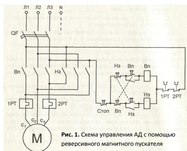
1. Вычертить схему управления двигателем основного движения станка 1К62 с помощью реверсивного магнитного пускателя.
