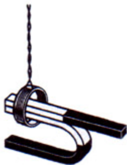
Рис.2. Рамка с током в радиальном магнитном поле
