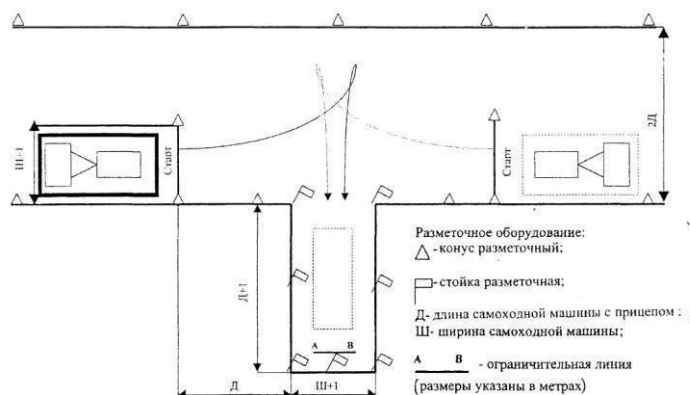
Рисунок 8. Постановка самоходной машины в агрегате с прицепом в бокс задним ходом
