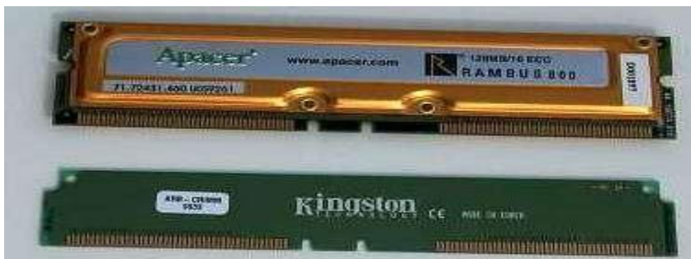
Рисунок 23 – Модули памяти RDRAM
