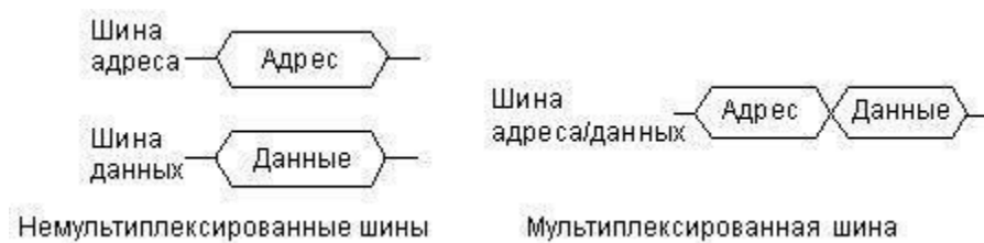
Мультиплексирование шин адреса и данных
