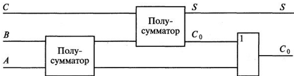
Рис. 8.6. Логическая схема одноразрядного сумматора.
