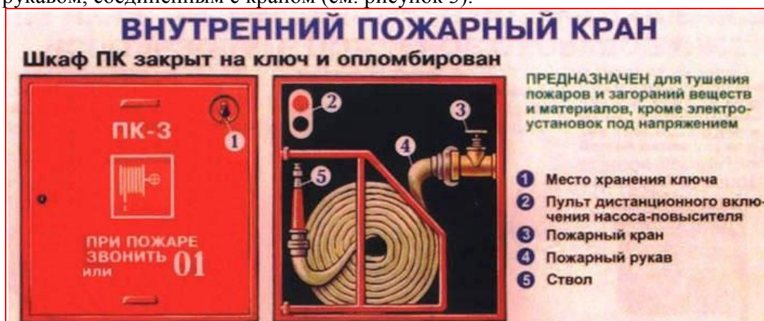
Рис. 3 – Внутренний пожарный кран
