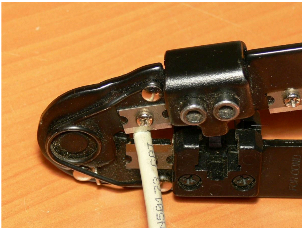
Рис. 4.6. Обрезка внешней изоляции на кабеле «витая пара»
