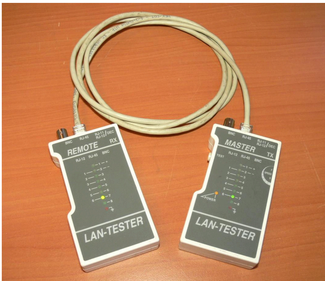
Рис. 4.10. Проверка качества заделки коннекторов RJ-45 с помощью специального тестера
