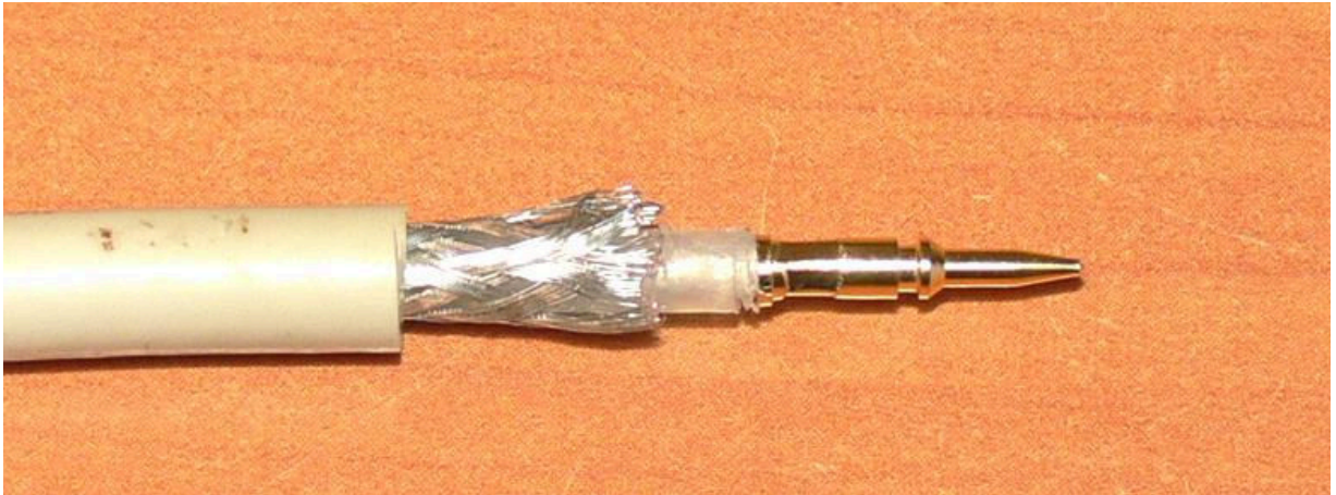
Рис. 4.3. Коаксиальный кабель RG-58 после установки и обжима центрального контакта
