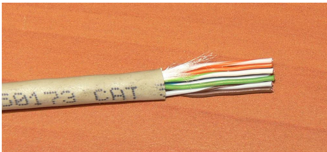
Рис. 4.7. Кабель «витая пара» с расплетенными и выпрямленными проводниками
