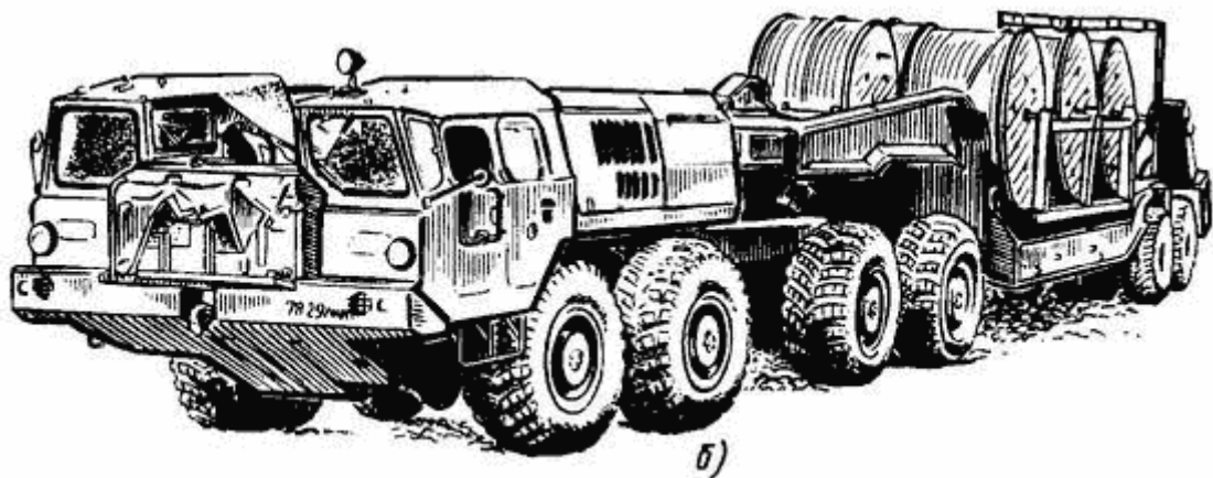
Рис. Перевозка грузов автомобильным транспортом: а - тягач с прицепом доставил на трассу воздушной линии электропередач железобетонные стойки опор; б - тягач с прицепом для перевозки и раскатки шести барабанов с проводом
