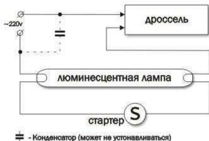
Схема подключения одной люминесцентной лампы через стартер
