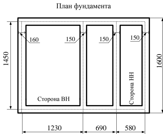
Рис.3. План фундамента КТП
