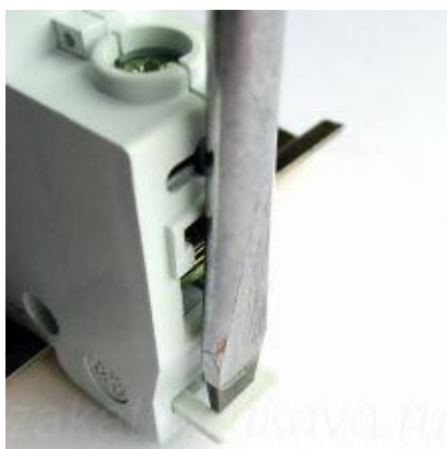
Крепление автомата на DIN-Рейку и снятие в неё.
