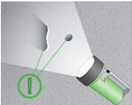
После окончания процесса проверяют состояние поверхности.
